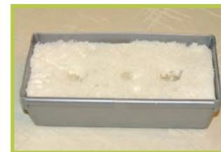
Découper les évidements pour les éprouvettes dans la mousse.
