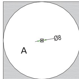
Avec les ciseaux, découpe grossièrement les gabarits pour les pièces (A, B, C) et fixe-les avec du ruban adhésif sur les contreplaqué.
