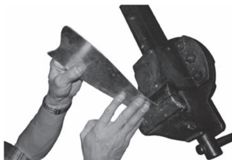
Plier à angle droit à 10 mm du bord
