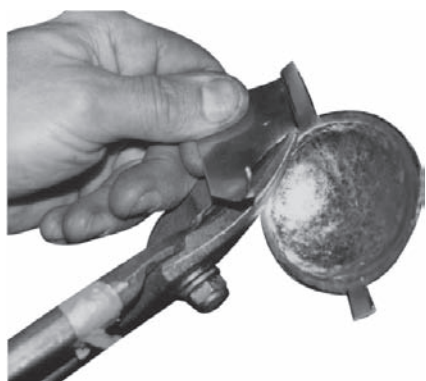
découper à l'aide de la cisaille à tôle
